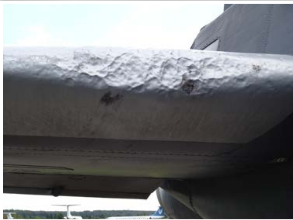
Стабилизатор самолета Ан-12 после пролета сквозь градовое облако
