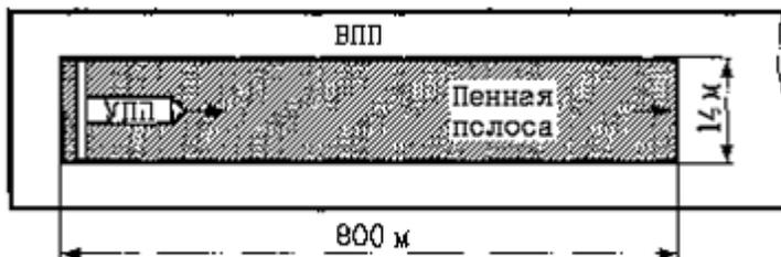
Рис.8.5. Схема нанесения пенной полосы одной машиной УПП
