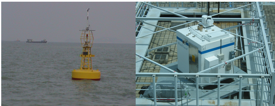
Рис. А4-8. Средства обнаружения сдвига ветра, установленные в начале 2000-х гг.: метеорологический буй (слева) и ЛИДАР (справа)
