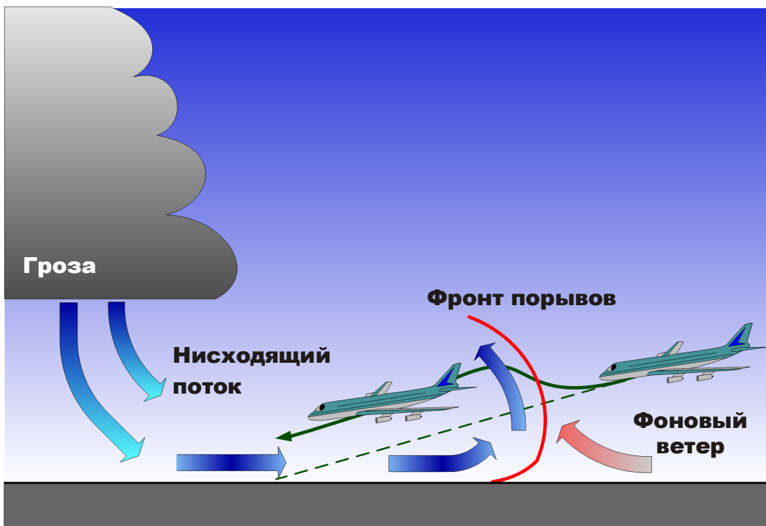
Рис. А4-4. Сдвиг ветра, вызванный фронтом порывов
