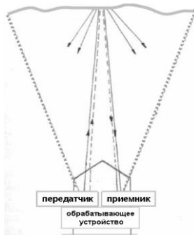
Рис. 5.2. Схема лазерного измерителя ВНГО
